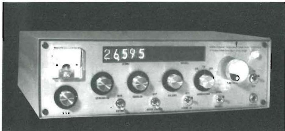
Fig. 7.17. - Ricevitore per 27 e 144 MHz con sintonia elettronica.
