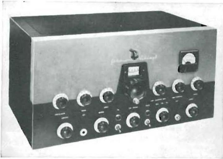
Fig. 9.1. - Aspetto di tipico trasmettitore da 100 watt fonia. L'apparecchio è provvisto di un solo strumento di misura, nei diversi circuiti mediante un commutatore.
