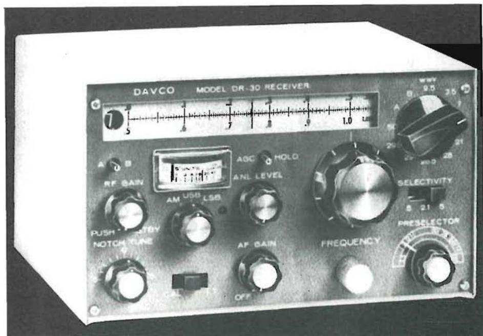
Fig. 8.13. - Ricevitore per gamme radioamatori (DAVCO mod. DR-30).
