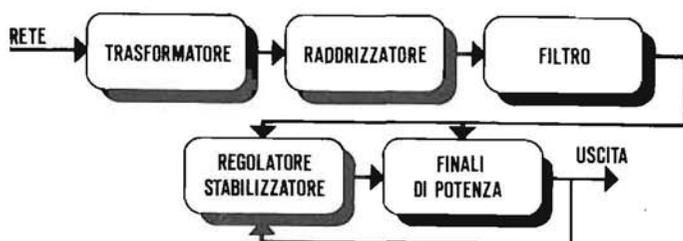
Fig. 6.17. - Schema a blocchi di alimentatore stabilizzato.
