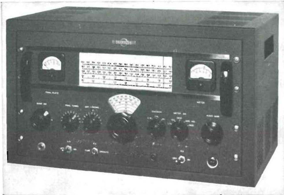
Fig. 11.21. - Aspetto esterno del trasmettitore Collins, mod. 32V-3.
